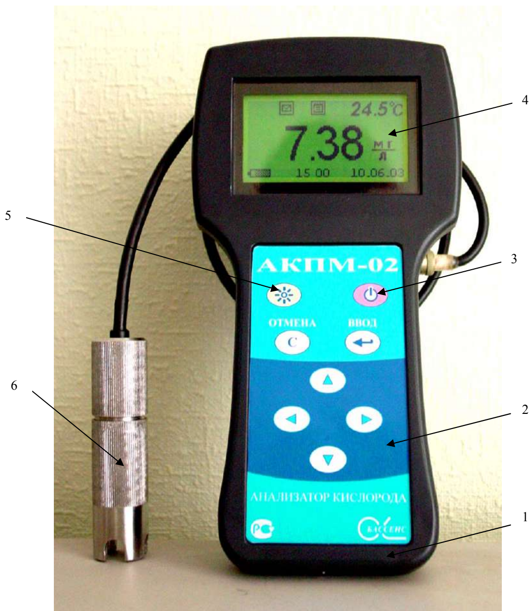
Рис. 4.1. Внешний вид анализатора кислорода АКПМ-1-02.
