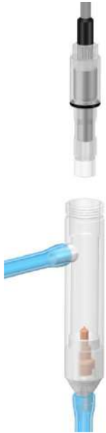
Рис. 3.9. Установка АСрО 2 в измерительную камеру
