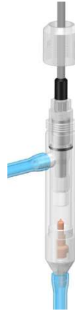
Рис. 3.10. Фиксация АСрО 2 в измерительной камере
