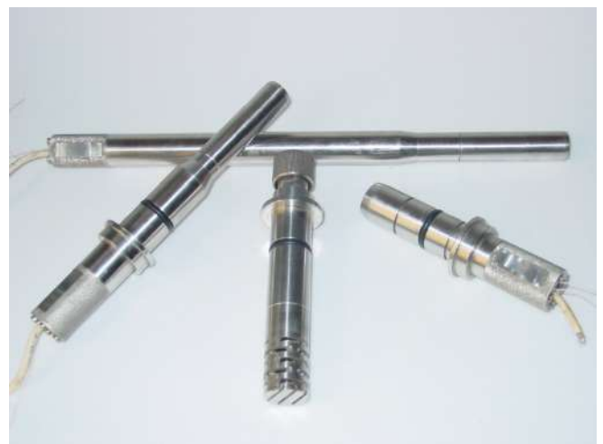
Рис. 3.6. Внешний вид стерилизуемых амперометрических сенсоров ACSrO 2 -06.
