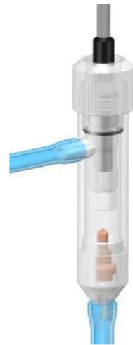
Рис.3.2. Внешний вид сенсора в измерительной камере.
